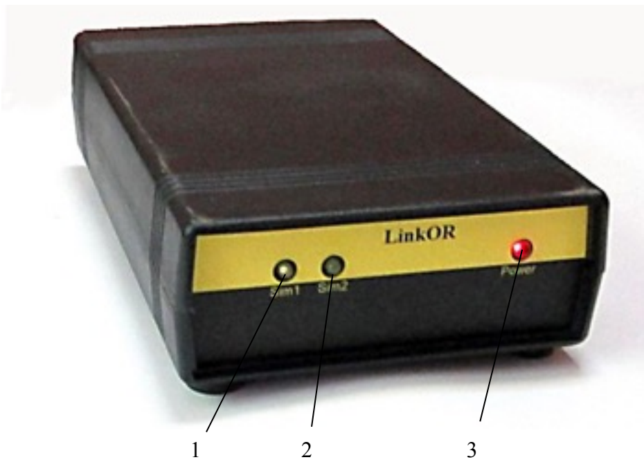
Рис.3.1 GSM- МОСТ (вид спереди)
