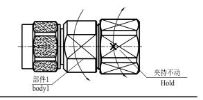
安装注意:安装时保证各端面清洁,无毛刺,金属屑.
