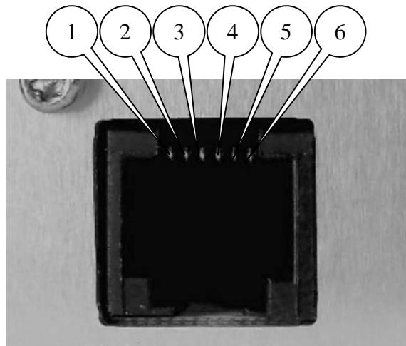
Рис.2.5.2 Разъём RJ11
