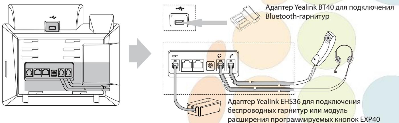
**Примечание:** для подключения адаптеров Yealink BT40 и Yealink EHS36 или модулей расширения программируемых кнопок EXP40 воспользуйтесь инструкцией на сайте или инструкцией, поставляемой в комплекте к подключаемому устройству.
