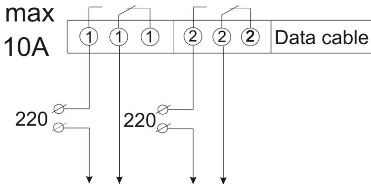
Рис 5.2 Схема подключения исполнительных устройств и охранных датчиков к ALARM module.
