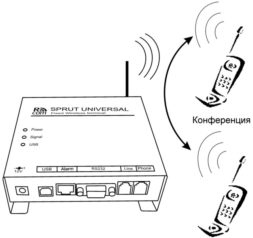
**Пример:** Вы звоните на SPRUT, после ответа устройства набираете номер телефона, с которым хотите установить связь. SPRUT переводит Вас в режим удержания и набирает этот номер. После ответа абонента SPRUT соединяет Вас с абонентом, для чего переходит в режим "конференция". Режим "конференция" используется обычно совместно с режимом "Обратный звонок" (Call Back).
